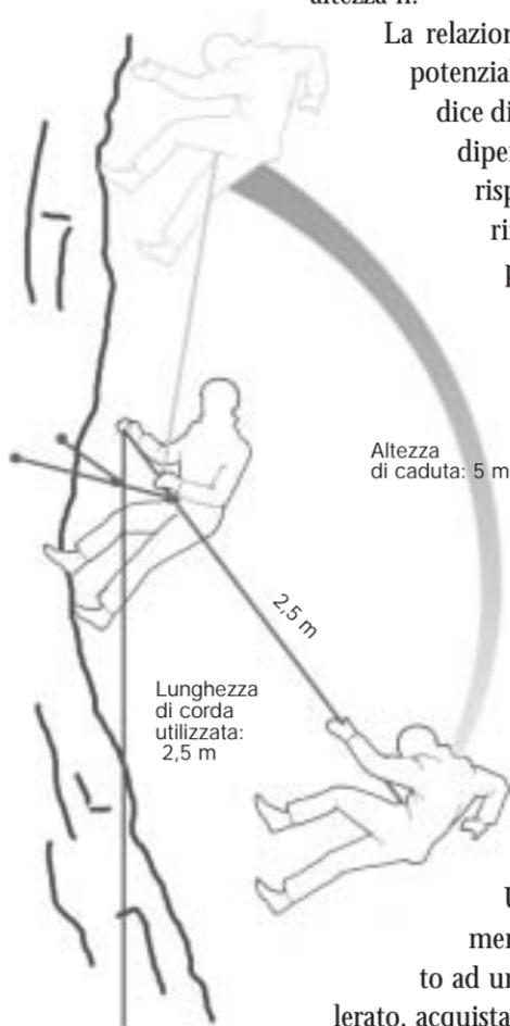
La relazione  $L=P * h$  misura l'energia potenziale del sistema, energia che si dice di posizione o di gravità perché dipende dalla posizione del corpo rispetto al livello scelto come riferimento dell'altezza  $h$ . Il primo di cordata, che dopo essere salito di 5 metri si ferma, è dotato di energia potenziale. Si tratta di una energia "immagazzinata" che dipende dall'oggetto e dalla forza di gravità che lo attrae verso il basso
